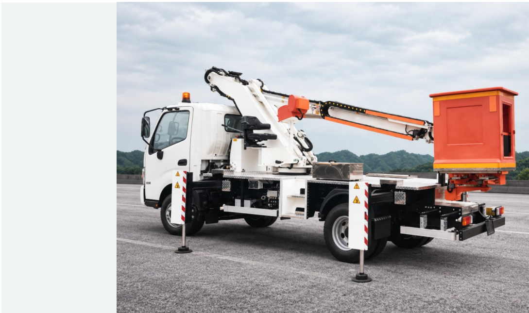
Fahrzeug-Hubarbeitsbühne mit orangefarbenem Arbeitskorb und ausgefahrenen Stützen – schräge Heckansicht.
