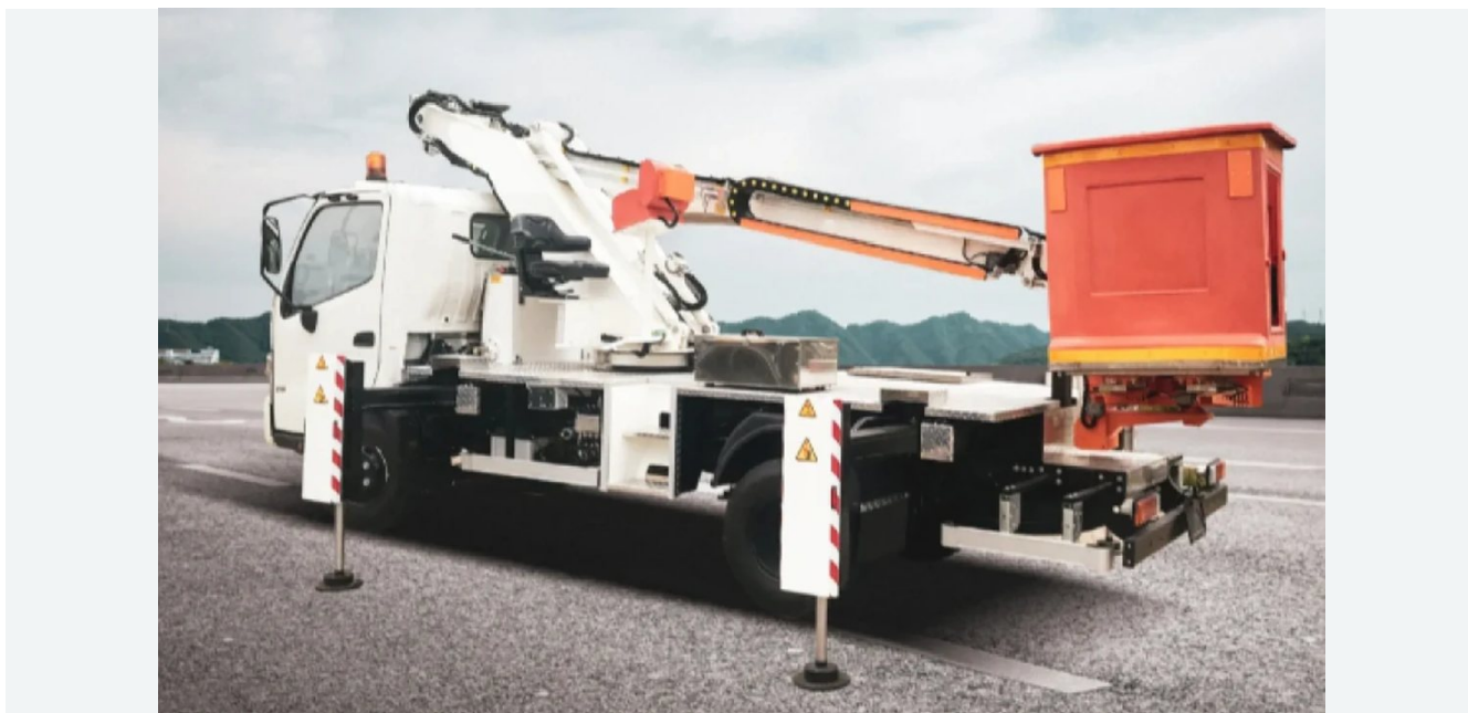
Plataforma elevadora sobre vehículo con cesta y estabilizadores laterales.
