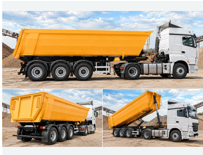
Semirremolque basculante: composición de tres vistas, incluida la caja elevada.
