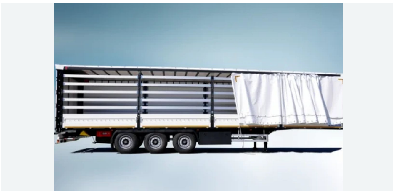
Semirremolque de lona y laterales abatibles con acceso lateral.
