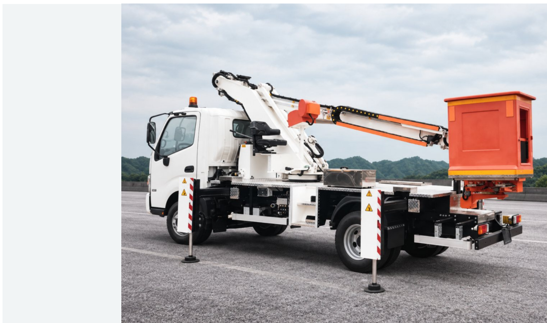
Nacelle élévatrice sur véhicule avec panier orange et stabilisateurs déployés – vue de trois quarts arrière.
