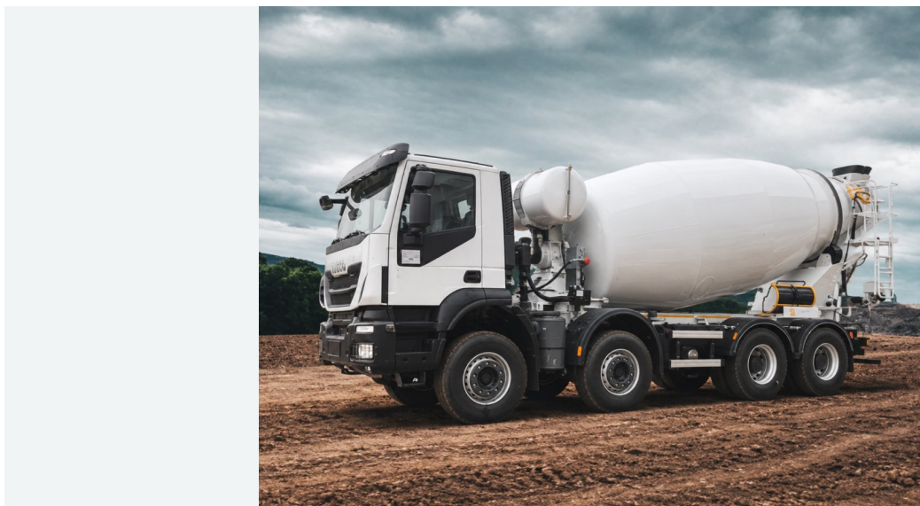
Camion malaxeur à béton blanc – vue de trois quarts avant.
