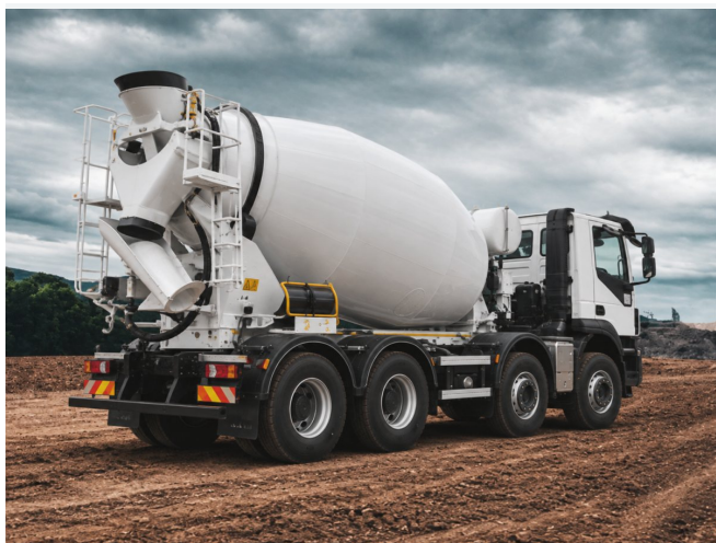
Camion malaxeur à béton blanc – vue de trois quarts arrière avec goulotte de déchargement.
